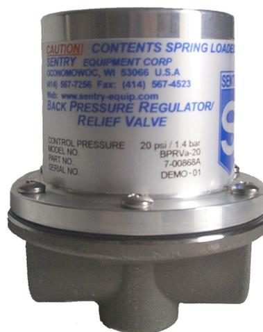
下記のようなシステムに設置する場合、背圧レギュレーター／安全弁(BPRV)は分析器入口圧力を約 20psig (1.4barg) の一定値に保ちます。この圧力は供給源圧力の変動やサンプル流量の変化にかかわらず保持されます。入口圧力が上昇すると、レギュレーターが開いてドレインへの流量を増加させます。この流れは一般にグラブ・サンプルとして使用されます。この装置は、圧力が過大に上昇した場合には、安全弁の機能も果たします。
